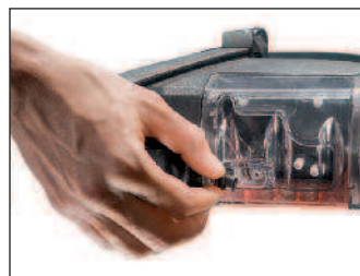
Режим непрерывной откачки конденсата для продолжительных измерений
