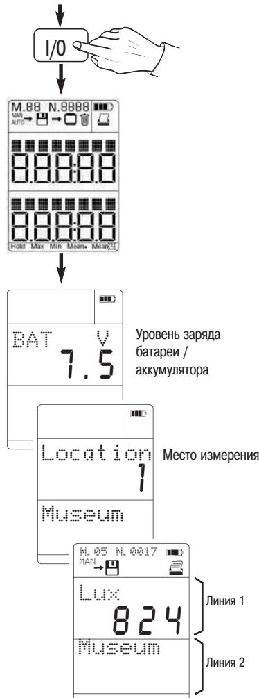
В процессе измерения данные функции можно включить нажатием следующих кнопок:
