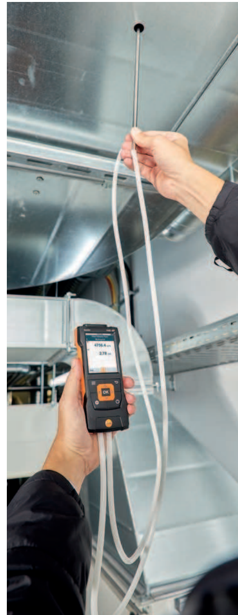
Для измерения объёмного расхода при высоких скоростях потока или в сильно загрязнённом воздухе мы рекомендуем использовать модель testo 440 dP с трубкой Пито
