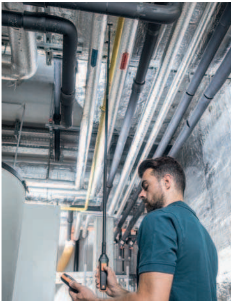
Все зонды скорости воздуха testo 440 для измерений в воздуховодах оснащены телескопической рукояткой (которую можно раздвинуть от 1 м до 2 м) со шкалой
